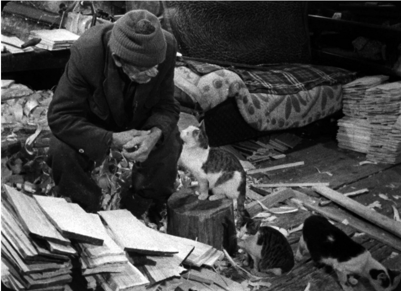
1 Szene aus dem Film E 1447 MITTELEUROPA, BAYRISCHER WALD – DER SCHINDELMACHER IN FRAUENBERG BEI DER ARBEIT
